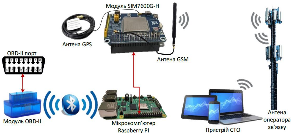
Рис. 1. Схема роботи пристрою віддаленої діагностики автомобіля.
