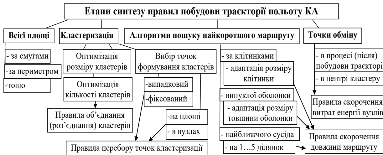
Рис. 1. Етапи синтезу правил побудови траєкторії польоту КА для збору даних з вузлів БСМ
